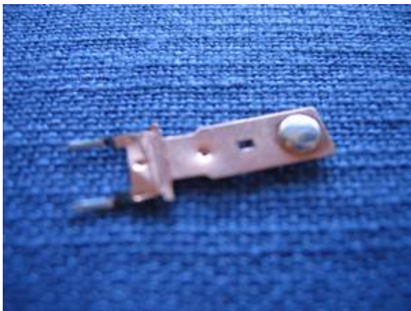
Der ausgebaute Schleiferkontakt
