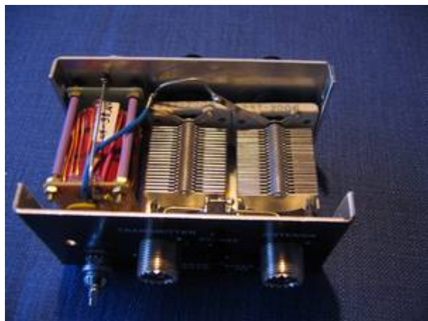
Der umgebaute MFJ 902 mit Schleiferspule nach DL8UZ
